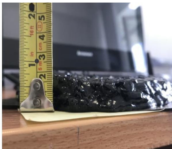
Сурет 13 –а)пресс, б) 17кН күшпен басылған резина-битум қоспасы
