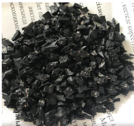
Сурет 11 – Резина –битум қоспасын дайындауға қосылатын резина үгінділері
