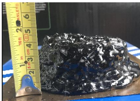
Сурет 12 –Резина үгінділері мен минералды тастар араластырылған битум
