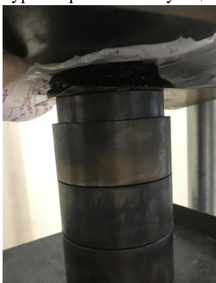
Сурет 13 –а)пресс, б) 17кН күшпен басылған резина-битум қоспасы
